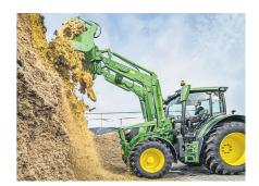
Materialverlust in hügeligem Gelände oder auf Auffahrrampen zu verhindern. Die Bedienung soll durch den neuen E-Joystick erleichtert werden, der frei konfigurierbare Tasten umfasst und eine Reversiertaste bietet, mit der die Fahrtrichtung geändert werden kann. Ein spezielles Handerkennungssystem ersetzt die zuvor eingesetzte Sicherheitsklappe.
